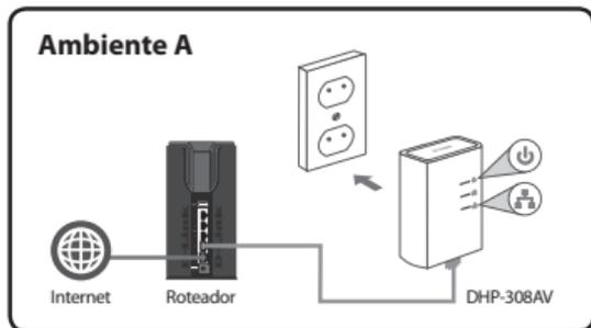
2. Ligue o PowerLine DHP-W310AV em uma tomada no ambiente que você deseja estender sua rede. Insira uma extremidade do cabo Ethernet no DHP-W310AV, e a outra ponta em seu computador. Você também pode ligar o DHP-W310AV através de uma rede Wi-Fi, com as informações que constam no cartão de configuração da rede WiFi.
