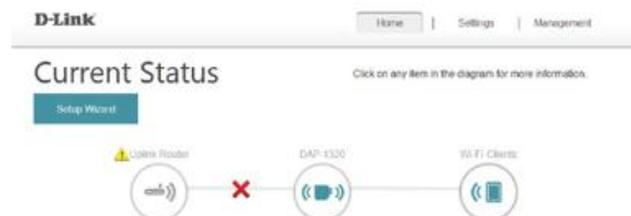
6- Para estender sua rede sem fio use o assistente de configuração, clique no botão **Setup Wizard** na parte superior esquerda da página de configuração
