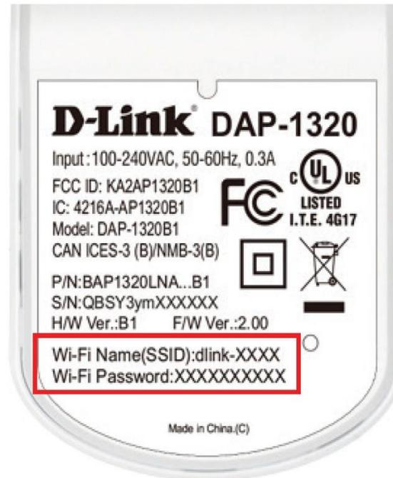
3- Para acessar a página de configuração conecte-se primeiro a rede sem fio do DAP-1320. Localize o **Wi-Fi Name (SSID)** e o **Wi-Fi Password** na etiqueta localizado na parte inferior do seu DAP-1320.
