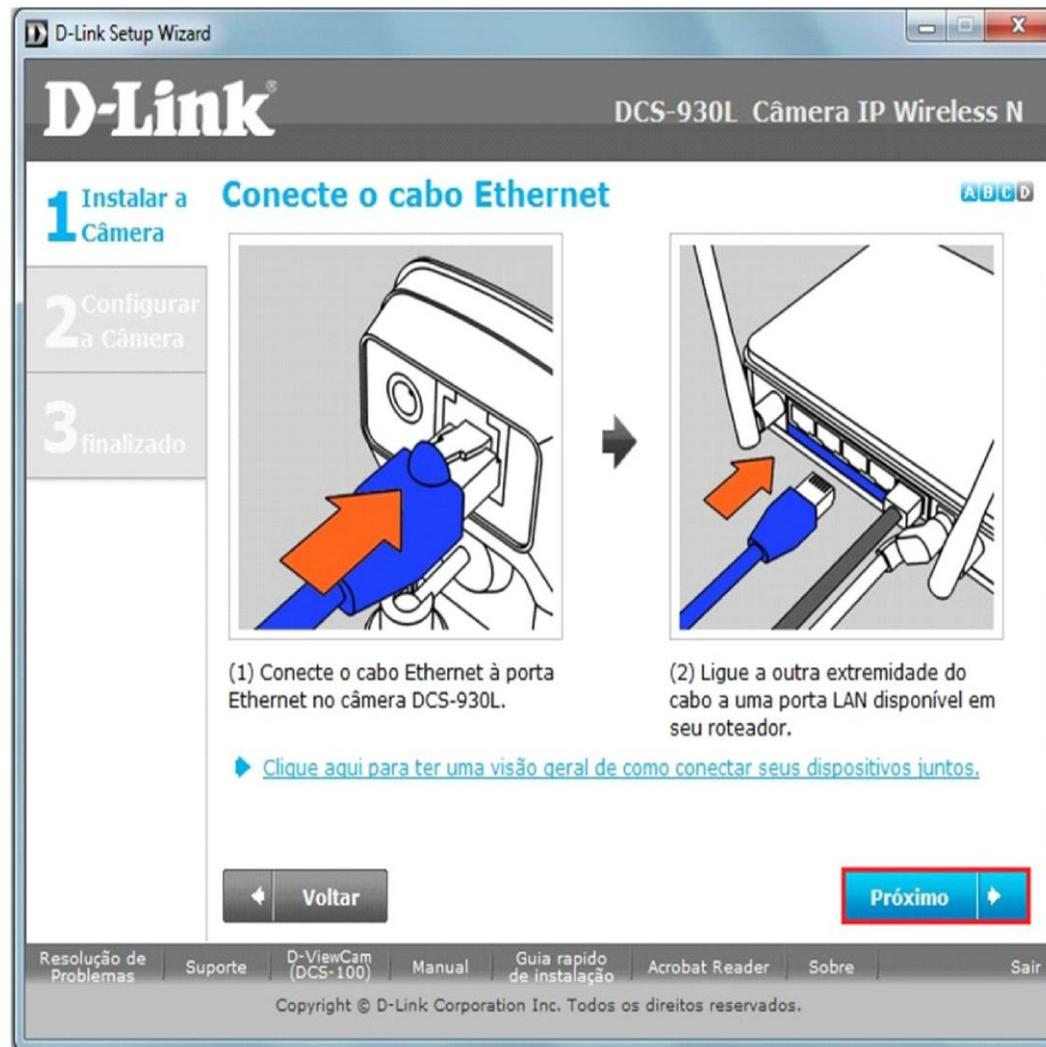
Conecte o cabo ethernet à porta **Ethernet** na câmera DCS-930L.
