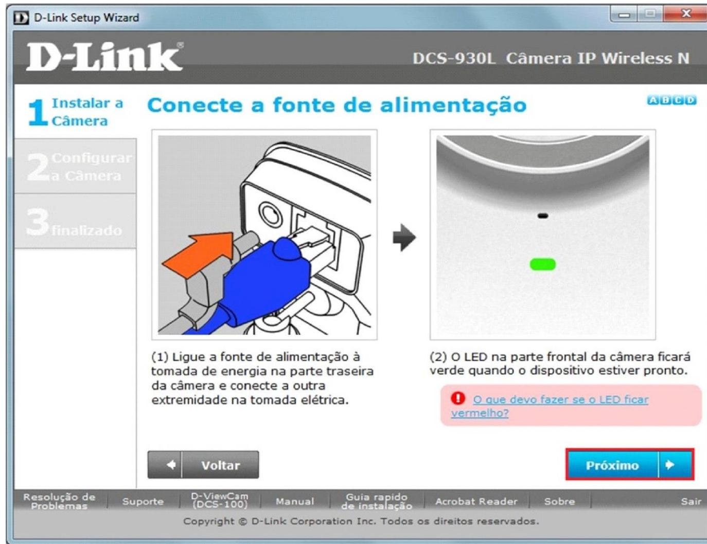
Ligue a fonte de alimentação à tomada de energia na parte traseira da câmera e conecte a outra ponta na toma elétrica. Verifique se o LED da parte frontal da câmera está aceso na cor verde.
