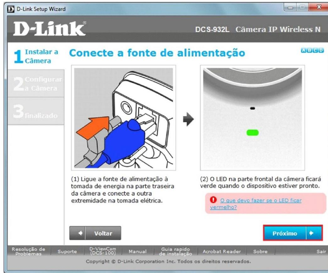
Ligue a fonte de alimentação à tomada de energia na parte traseira da câmera e conecte a outra ponta na toma elétrica.
