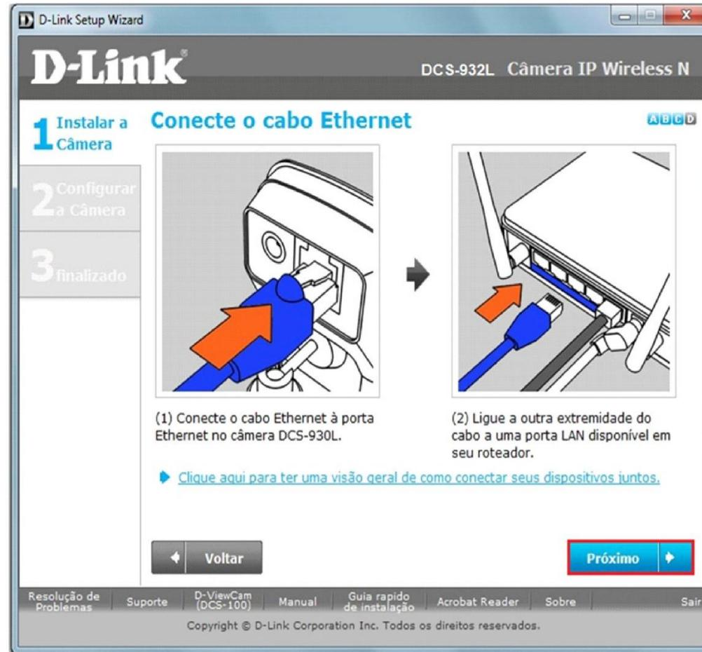
Conecte o cabo ethernet à porta **Ethernet** na câmera DCS-932L.
