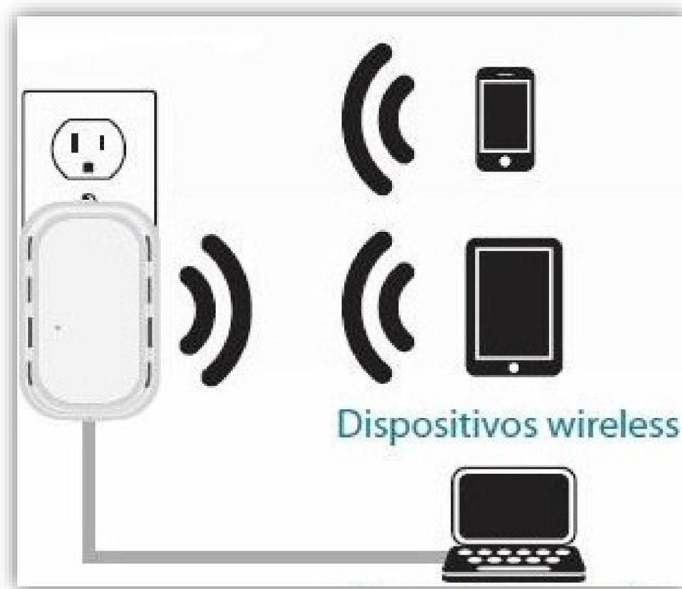
2- Primeiramente conecte a rede Wireless do DIR-505, após se conectar à rede WiFi do DIR-505, abra o navegador de internet e digite na barra de endereços `http://192.168.0.1` e tecele Enter.
